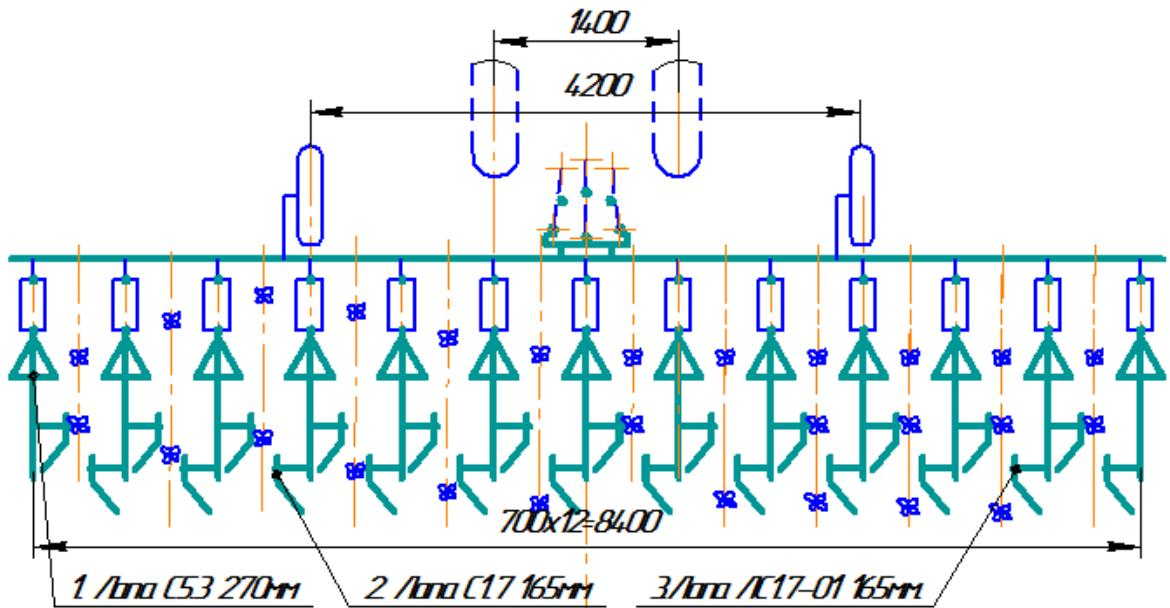
Рис 14 Схема расположения рабочих органов для работы в междурядях 70 см
