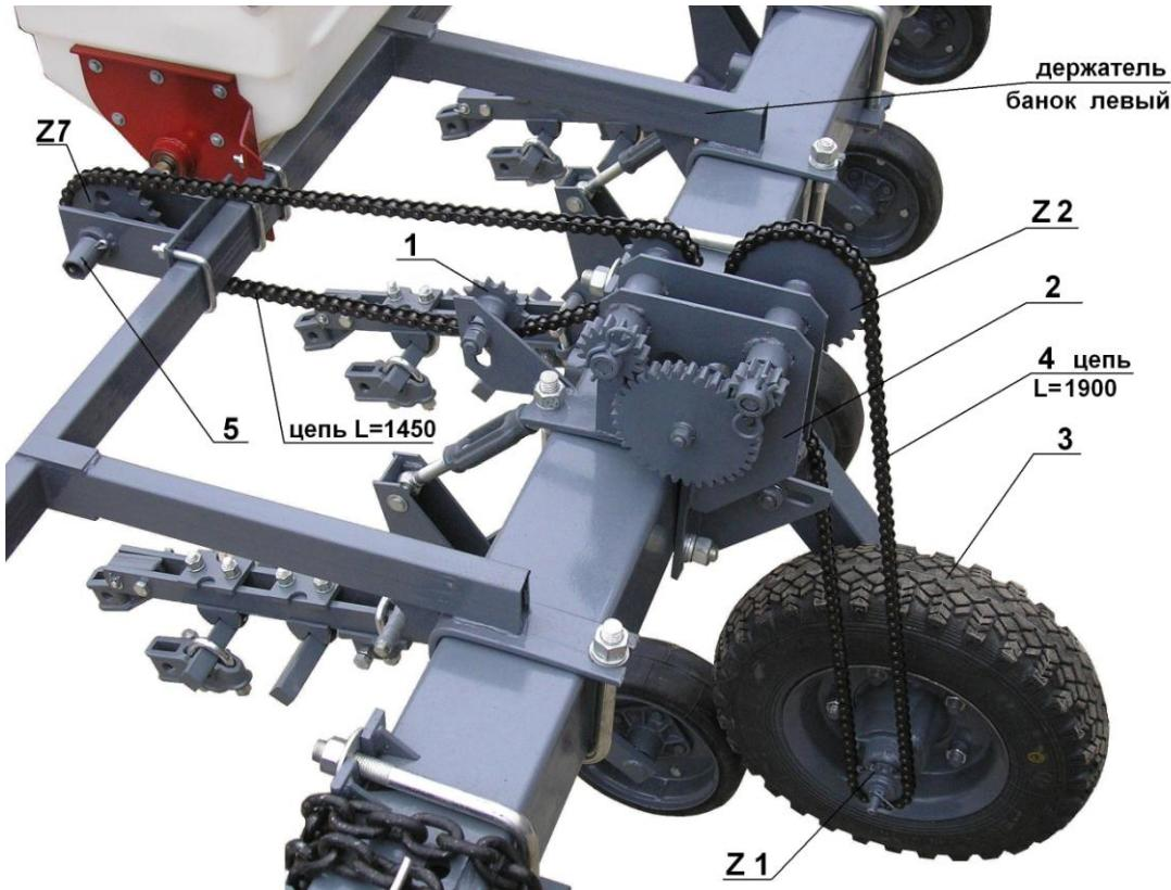
**Рис. 9. Механизм передач:**
