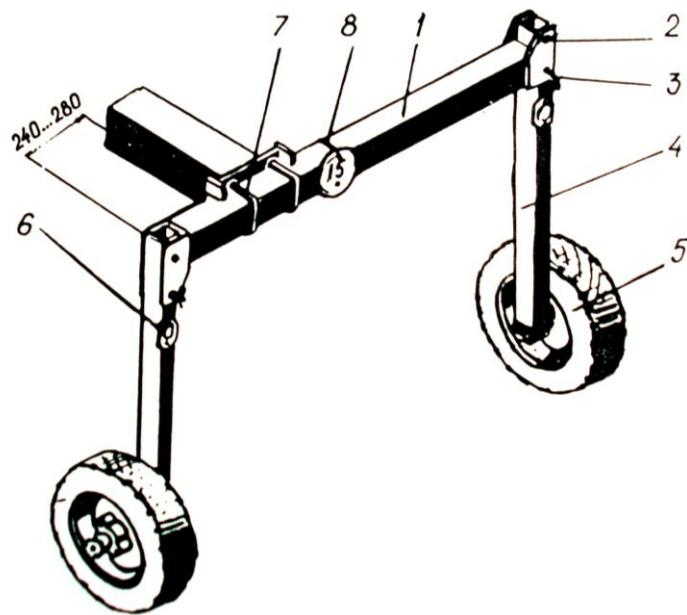
**Рис. 5. Положение несущих колес при транспортировании культиватора:**
