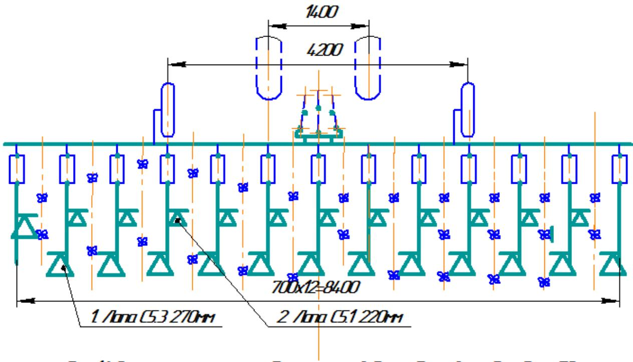
Рис. 16 Схема расположения рабочих фронтов для работы в междурядях 70 м
