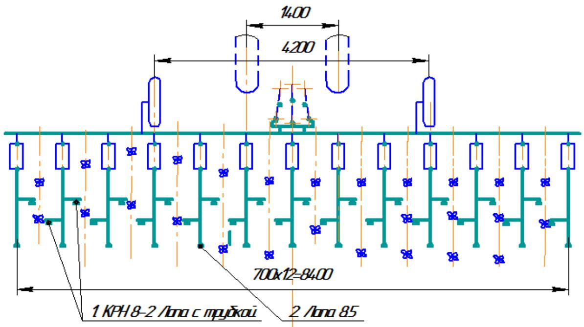
Рис 15 Схема расположения рабочих органов на глубкое рыхление в междурядях 70 см
