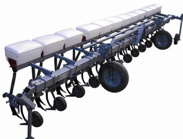
**Рис. 1. Культиватор-растениепитатель навесной для высокостебельных культур КРН-8,4С (общий вид с подкормочным приспособлением в рабочем положении).**
