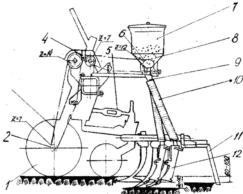
**Рис. 8. Схема культиватора с подкормочным приспособлением:**
