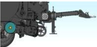
Установка прицепного устройства в верхнем положении над карданной передачей
