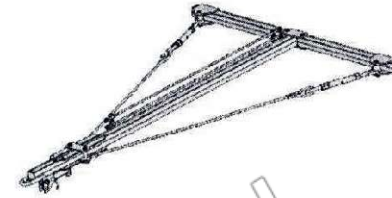
Рисунок 51- Сцепка СКП 02.00.000Б для составления посевного комплекса из 2-х сеялок
